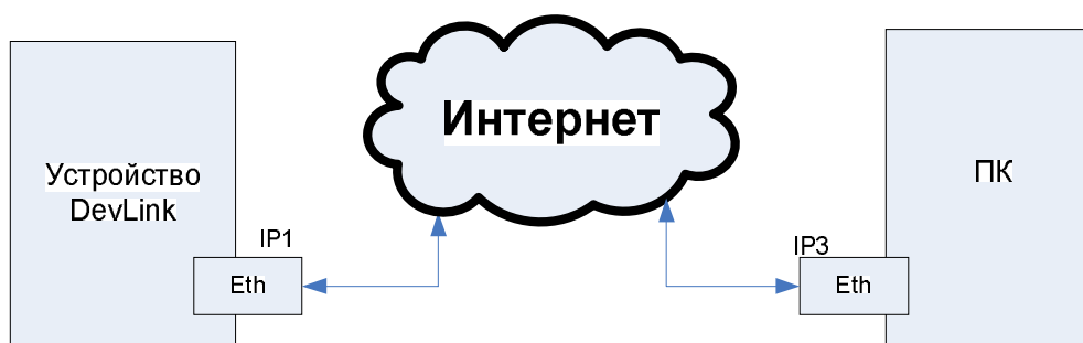
Рисунок 5.3 – Схема Ethernet– Internet – Ethernet
